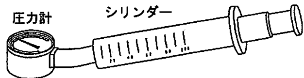
図1 シリンダーによるボイルの法則の実験
